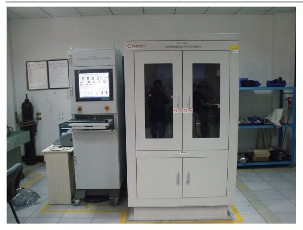
本试验台可对目前国内货机主流货舱系统的动力驱动组件(PDU)进行功能维修测试,包括各种客改货机以及全货机,例如B737、B777、B747、A320、A330等。
