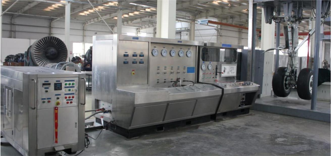
本项目是以 B737 为背景机型建设的仿真与教学实验室，系统主要包括液压动力源、液压组件测试台、B737 主起落架结构主体和起落架收放及刹车控制台。起落架收放和刹车控制台的动力来自液压动力源并通过液压组件实验台输出，可提供 3000 psi、30 L/min 的动力。液压油为航空蓝油，输入控制台后分 2 路：刹车（无回路，有显示）和收放（回路有背压）。
