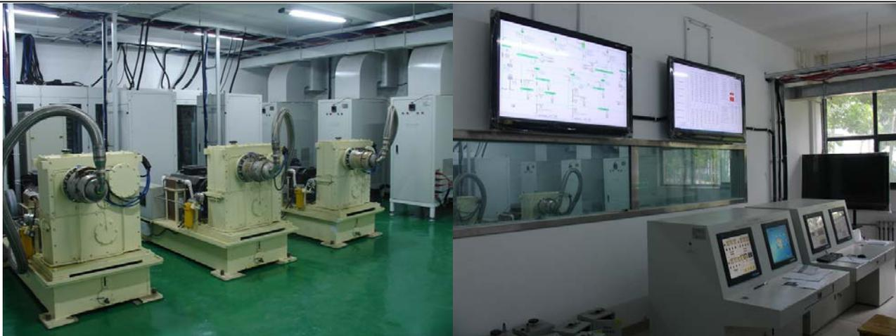
本项目是以 B737NG 为基础机型建设的电源实物在回路实验室，可以完成 B737 飞机发电过程以及全机电网模拟实验。
